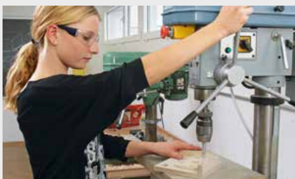
Perceuse d'établi: utiliser des moyens auxiliaires
