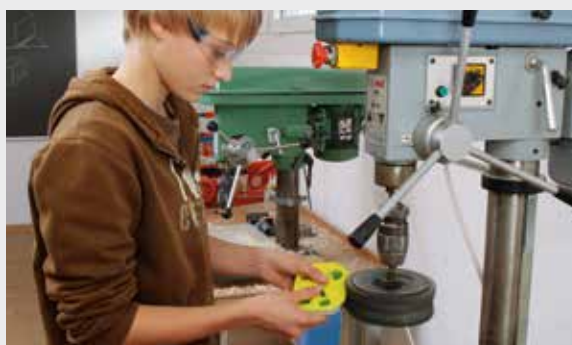
Ponceuse à tampon: attention au sens de rotation
