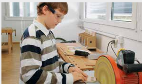
Ponceuse à disque: serrer les doigts
